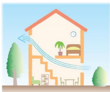
開口部を2か所以上開けて、風の入口と出口を確保。開口部の位置に高低差があると風が通りやすくなります。
